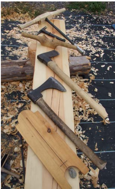
Fr.vå: Nyttillverkade verktyg efter äldre modeller som används under kursens gång. Foto: Anna Johansson. Kursledare Anna visar hur man använder lodbrädan under behuggningsmomentet. Fotograf: Agne Niklasson
